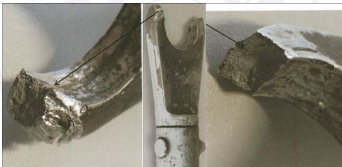
Figura 3 – Detalhe da ruptura por sobrecarga do Tube Assy-Aft Push-Pull do trem de pouso direito.
