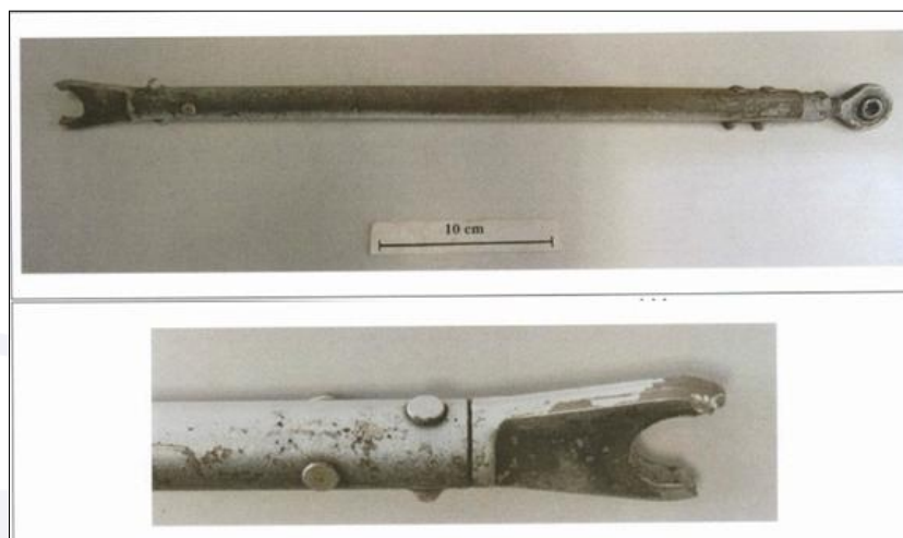
Figura 2 – Vista da ruptura do Tube Assy-Aft do trem de pouso direito.
