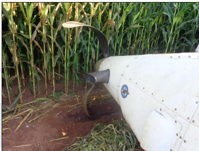
Figura 4 - Passo bandeira, deformação das pás e sulco no solo.
