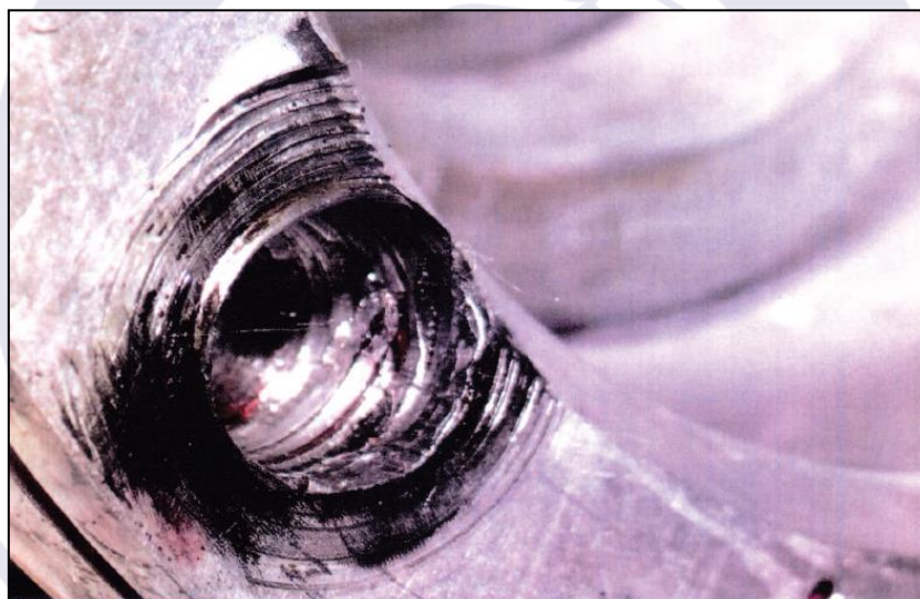
Figura 4 - Vista do dano na rosca do interior da base da pá.
