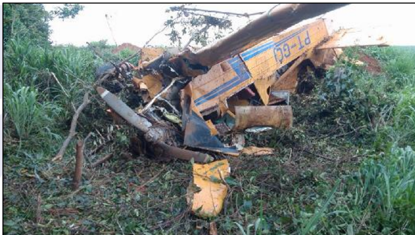
Figura 1 - Vista frontal da aeronave após a colisão contra o solo.
