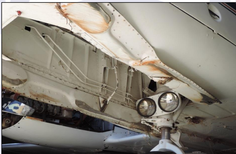
Figura 3 - Marcas de atrito da parte interna das portas do trem de nariz com o solo.
