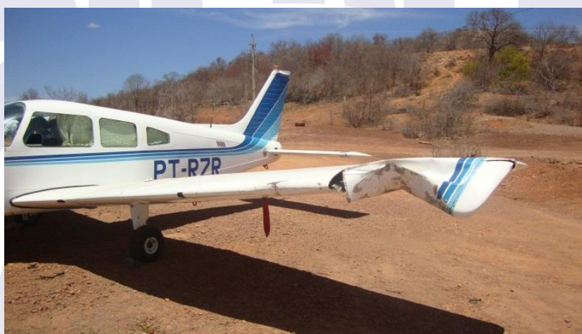
Figura 1 - Avaria na asa esquerda da aeronave.
