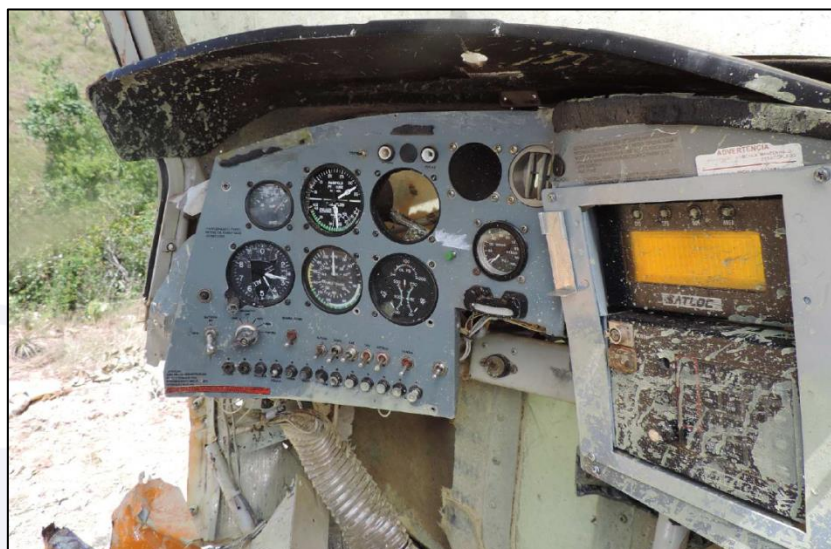
Figura 5 - Painel da aeronave com o DGPS.
