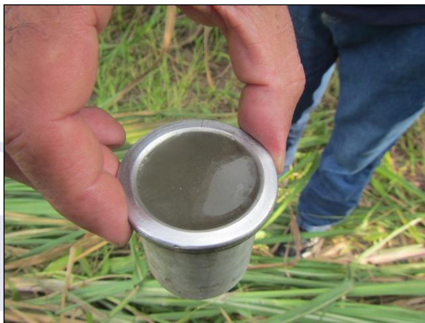
Figura 2 - Aspecto do combustível coletado, com aparência diferente da gasolina de aviação.]
