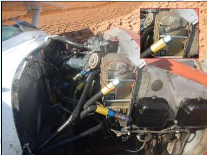
Figura 3 - Mangueira de óleo solta
