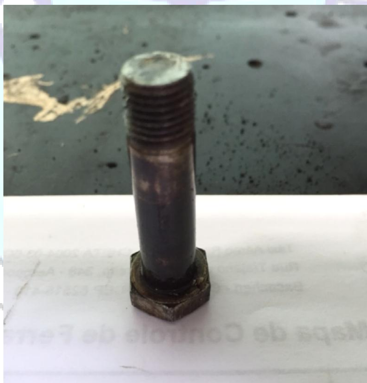
Figura 4 - Parafuso de articulação do braço de retração do trem de pouso, PN NAS464P6-18.
