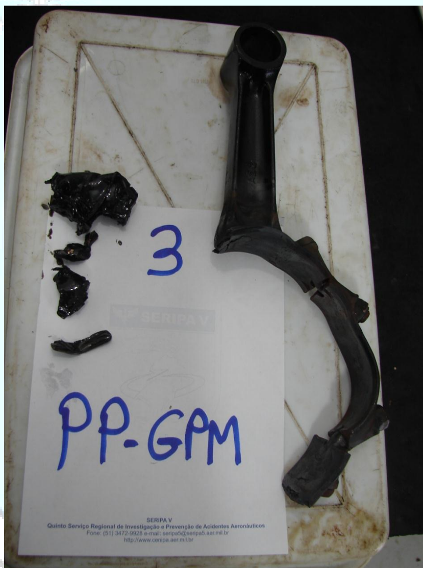
Figura 3 – Biela e componentes encontrados no cilindro nº 3.
