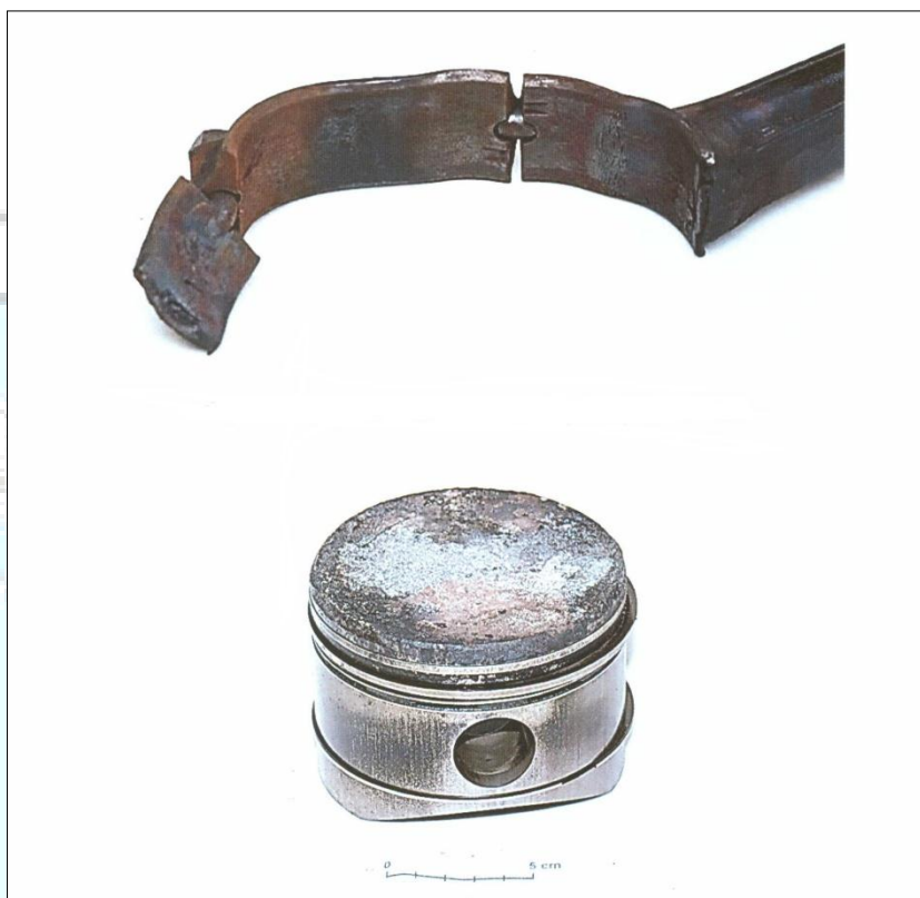
Figura 4 – Material com dano por superaquecimento (biela e cabeça do cilindro nº 3).
