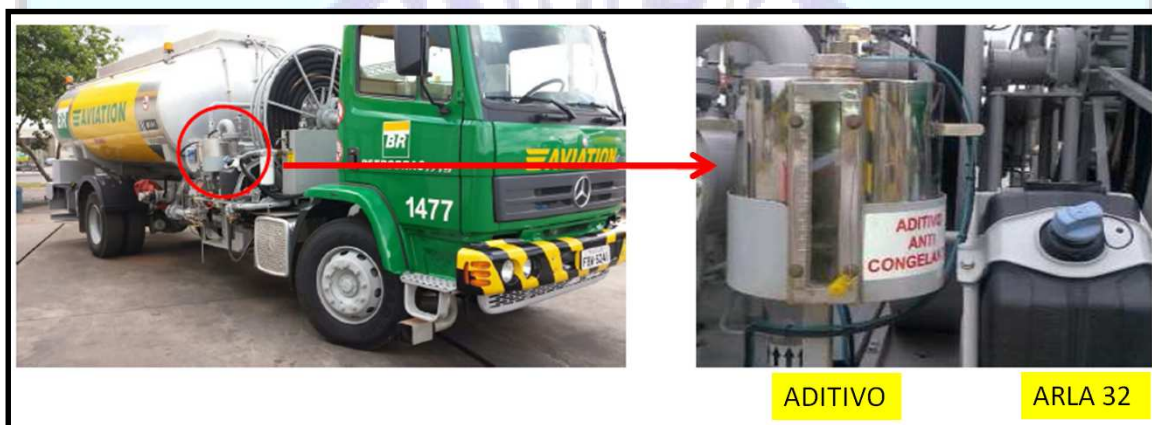
Figura 7 - CTA 1477. Em destaque os reservatórios de aditivo e ARLA 32.
