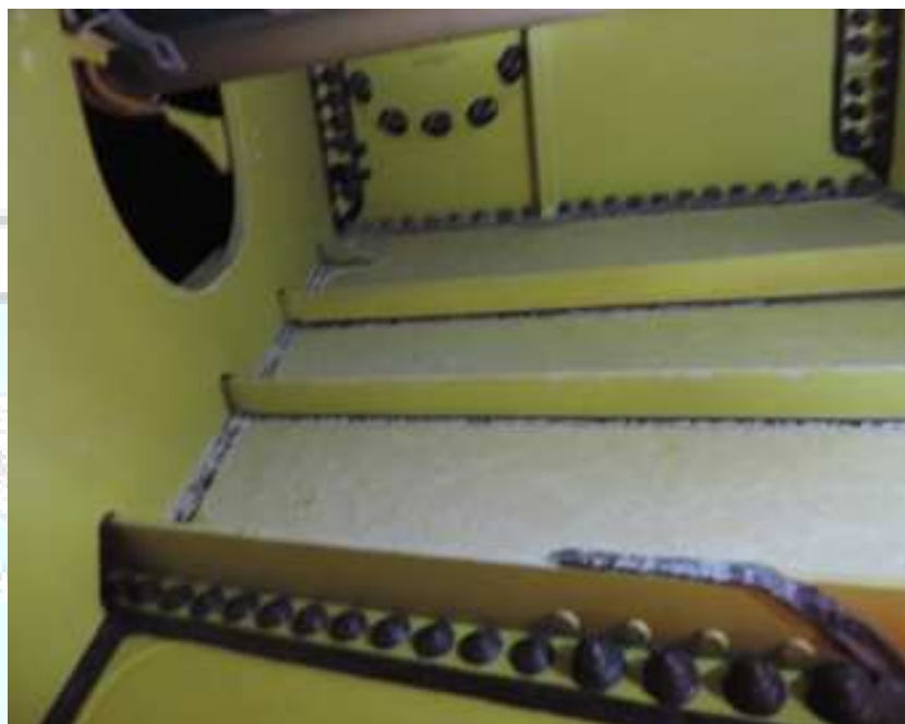
Figura 2 – Material esbranquiçado nos tanques de combustível do PP-EMO.
