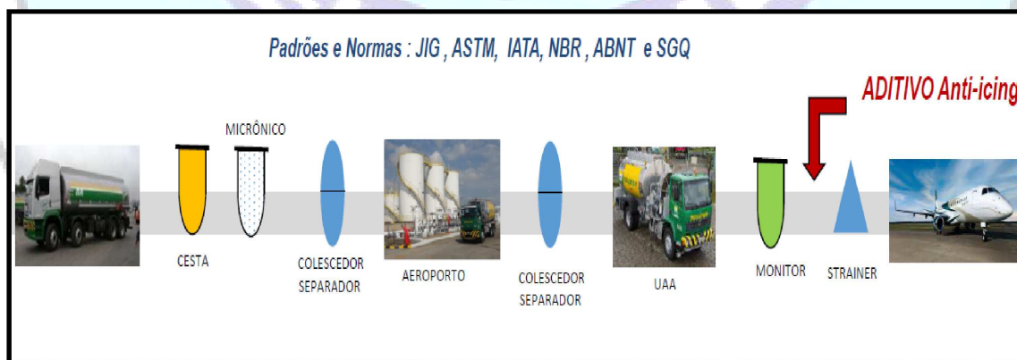
Figura 9 - Aditivação do combustível após todos os processos de filtragem.
