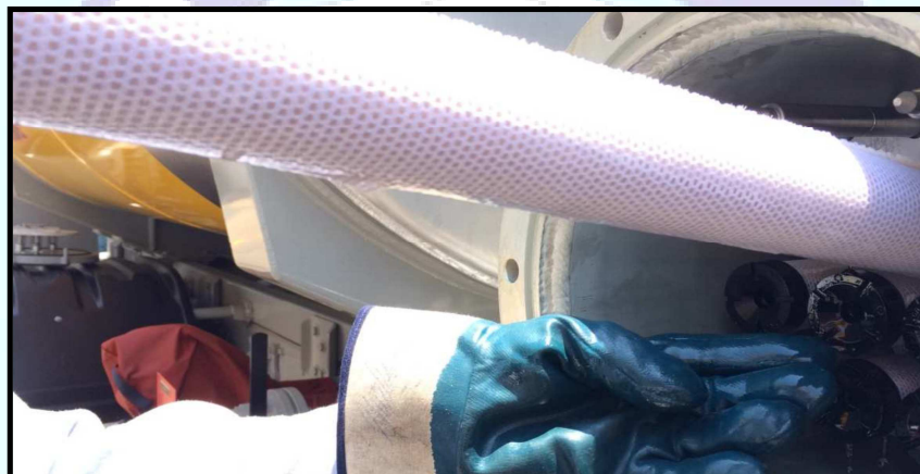
Figura 4 - Filtro do Caminhão Tanque Abastecedor (CTA) 1477 íntegro.
