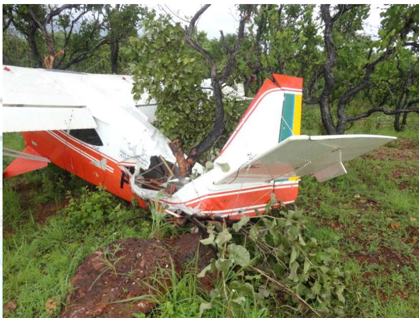
Figura 8 - Danos causados pelo segundo impacto.
