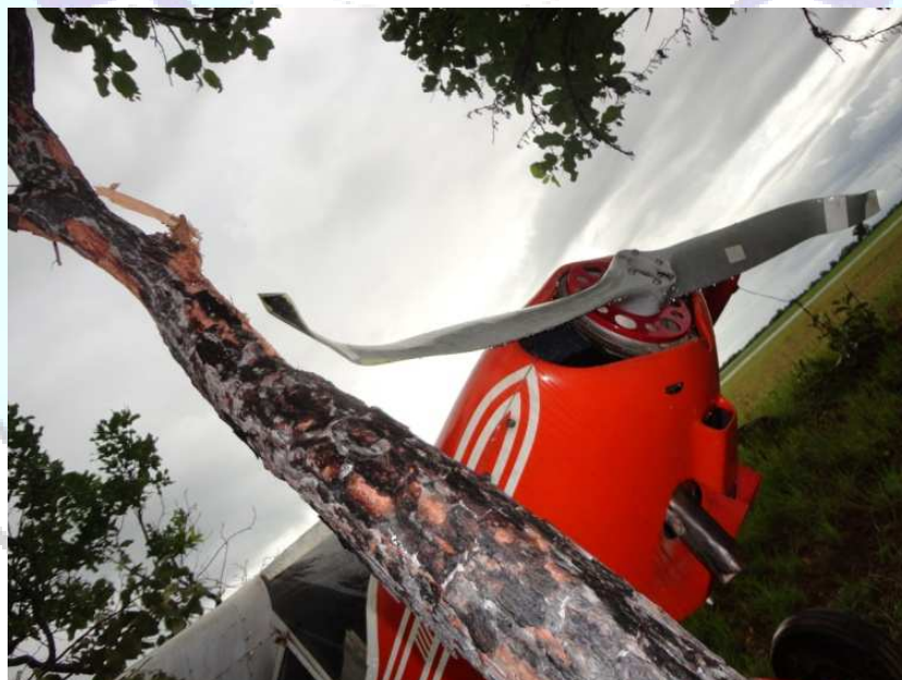
Figura 7 - Hélice envergada para frente.
