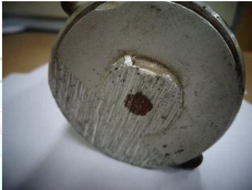
Figura 2 - Terminal rotulado danificado.
