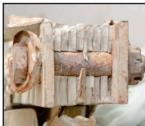
Figura 22 e 23 - Detalhes das fraturas internas da mesa inferior e superior – asa direita.
