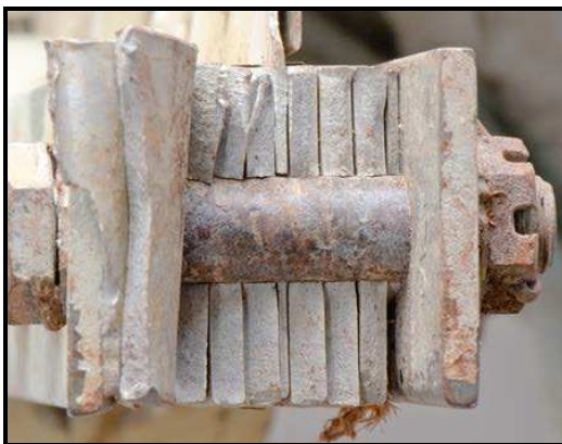
Figuras 25 e 26 - Detalhes das fraturas internas da mesa superior e inferior – asa esquerda.
