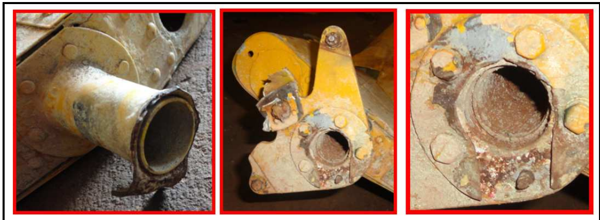
Figura 15 – Mosaico com detalhes do ponto de fixação do estabilizador horizontal à fuselagem.
