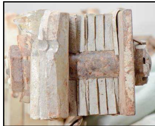
Figuras 25 e 26 - Detalhes das fraturas internas da mesa superior e inferior – asa esquerda.
