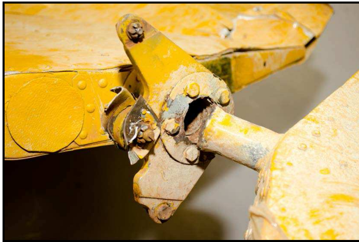
Figura 16 - Detalhe da região fraturada.
