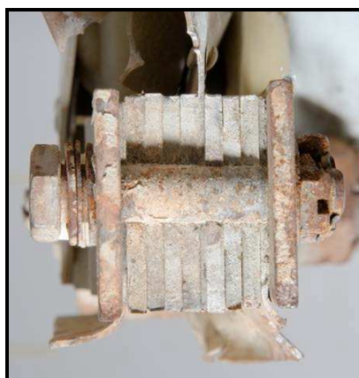
Figura 22 e 23 - Detalhes das fraturas internas da mesa inferior e superior – asa direita.
