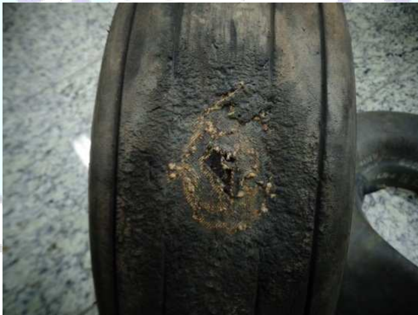
Figura 1 - Danos no pneu com característica de travamento da roda.
