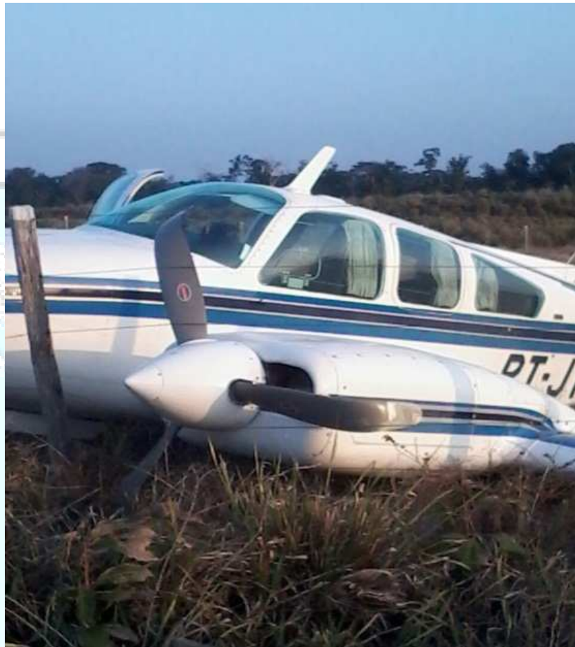
Figura 2 - Situação das pás da hélice esquerda após a ocorrência.
