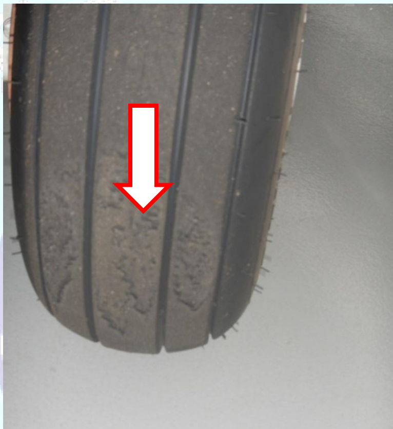
Figura 2 - Marcas de superaquecimento no pneu.
