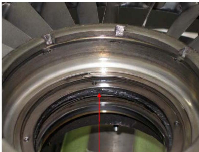
Slidt og beskadiget kulpakning (Carbon seal)
