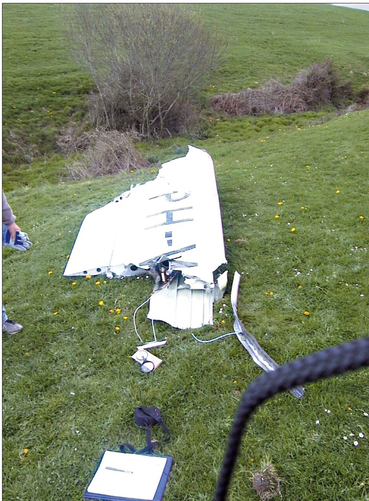
Figura C-6. Restos de semiala interior izquierda
