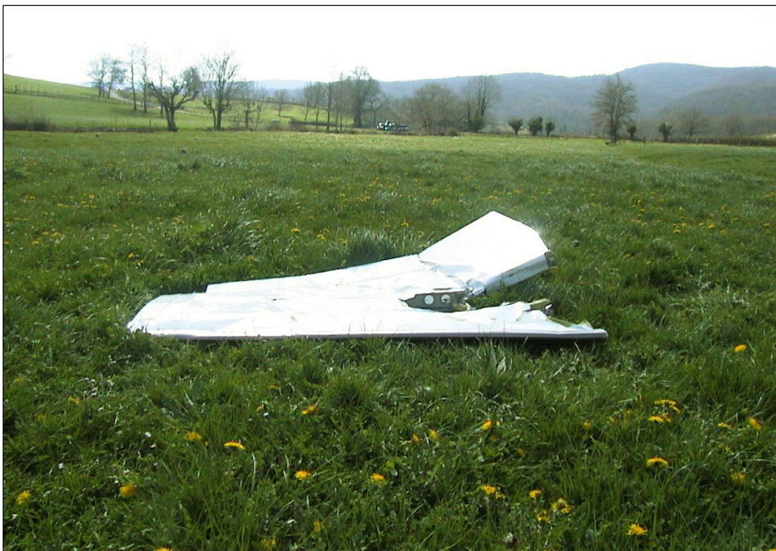
Figura C-5.1. Restos de estabilizador derecho (parte interior)
