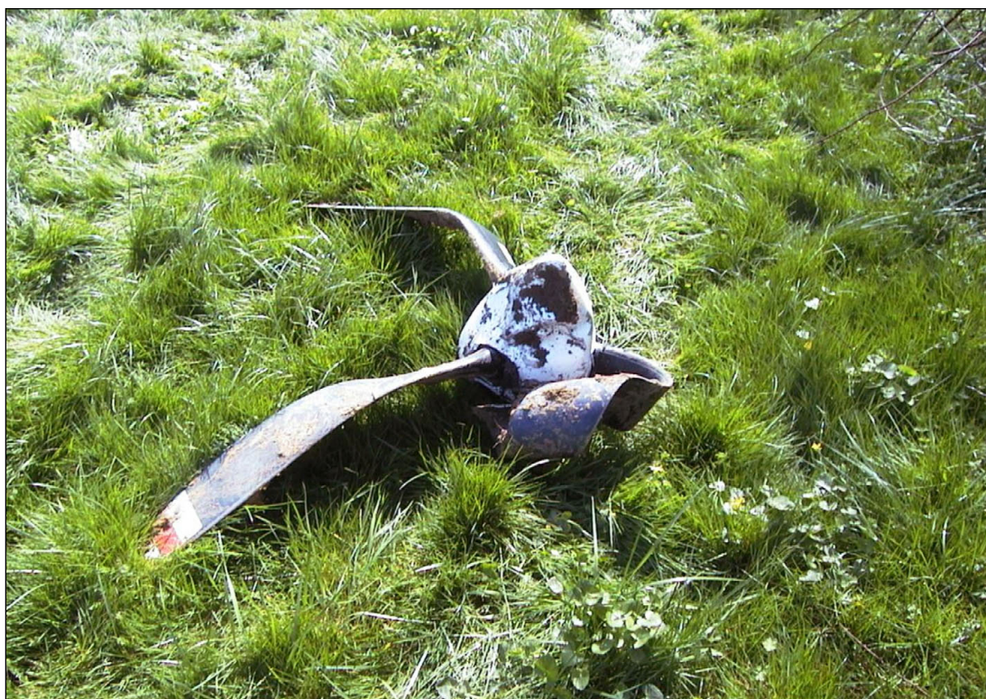
Figura C-3. Restos de la hélice
