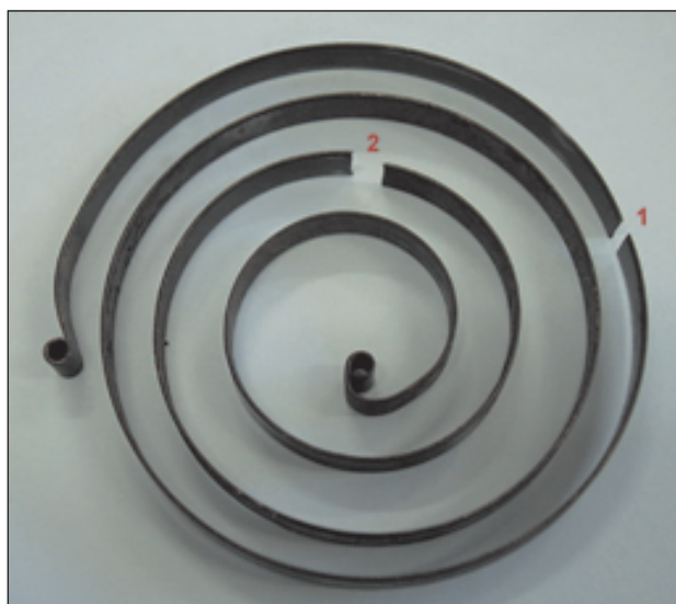
Figura 5. Muelle de impulso magneto izquierda.
