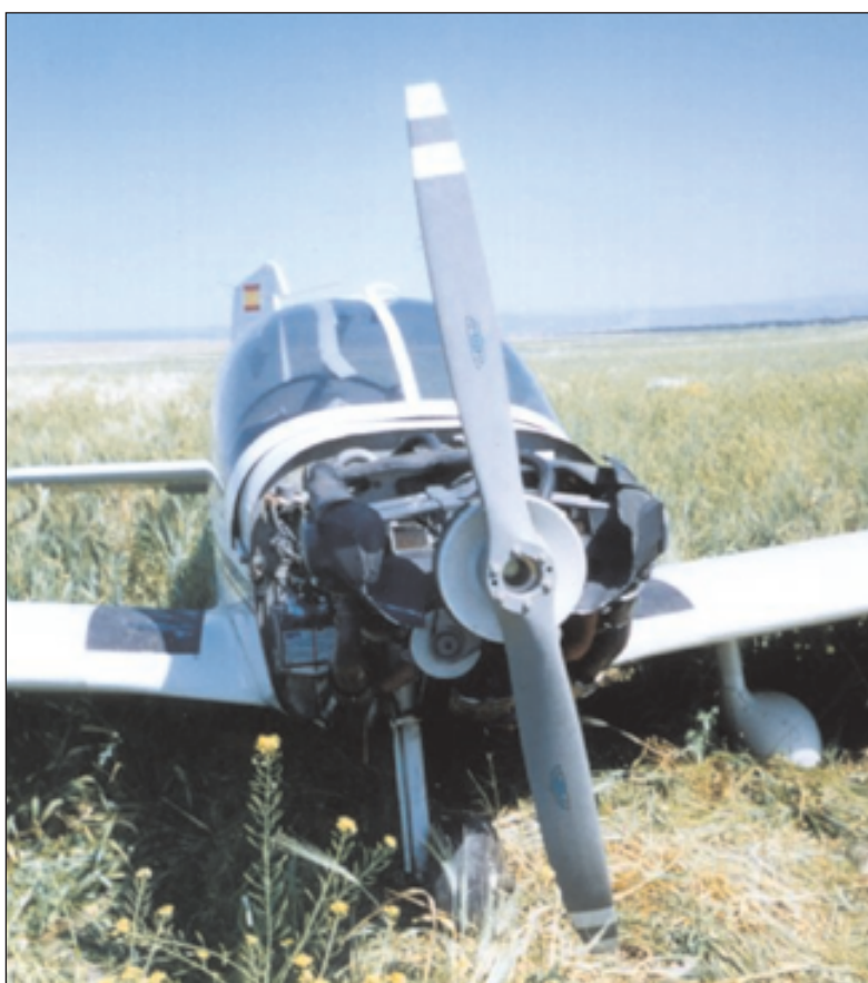
Figura 4. Pala de la hélice deformada.
