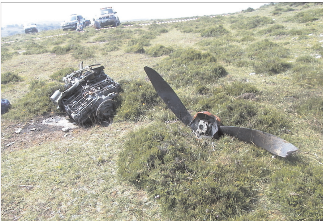
Figura C-3. Motor y hélice desprendidos
