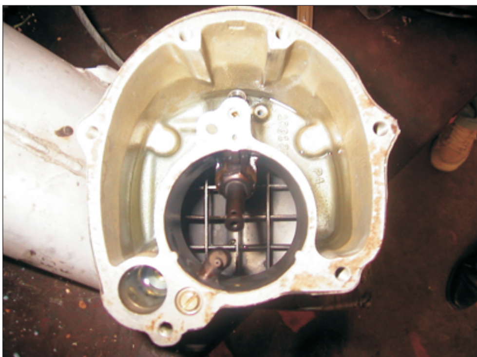
Foto 3. Cubeta del carburador. Al fondo puede verse el combustible que contenía
