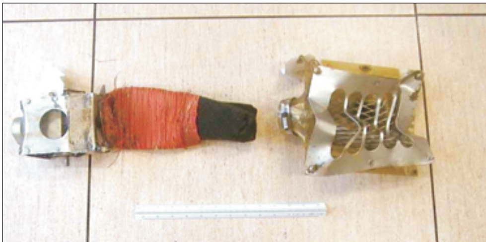
Foto 1. Filtro de aire en su camino hacia la entrada al inyector, tras ser absorbido
