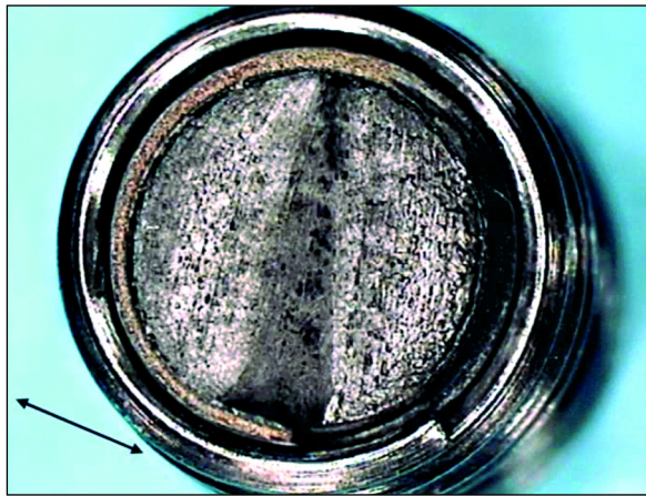
Figura 5. Dirección de aplicación de la carga en la zona de fractura
