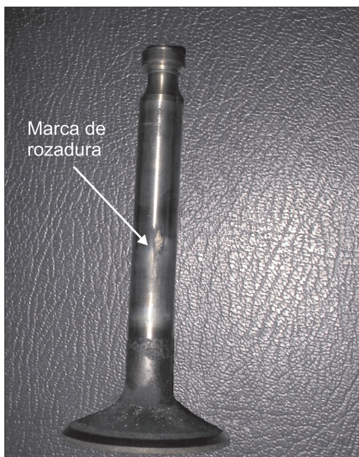
Figura 2. Estado de la válvula
