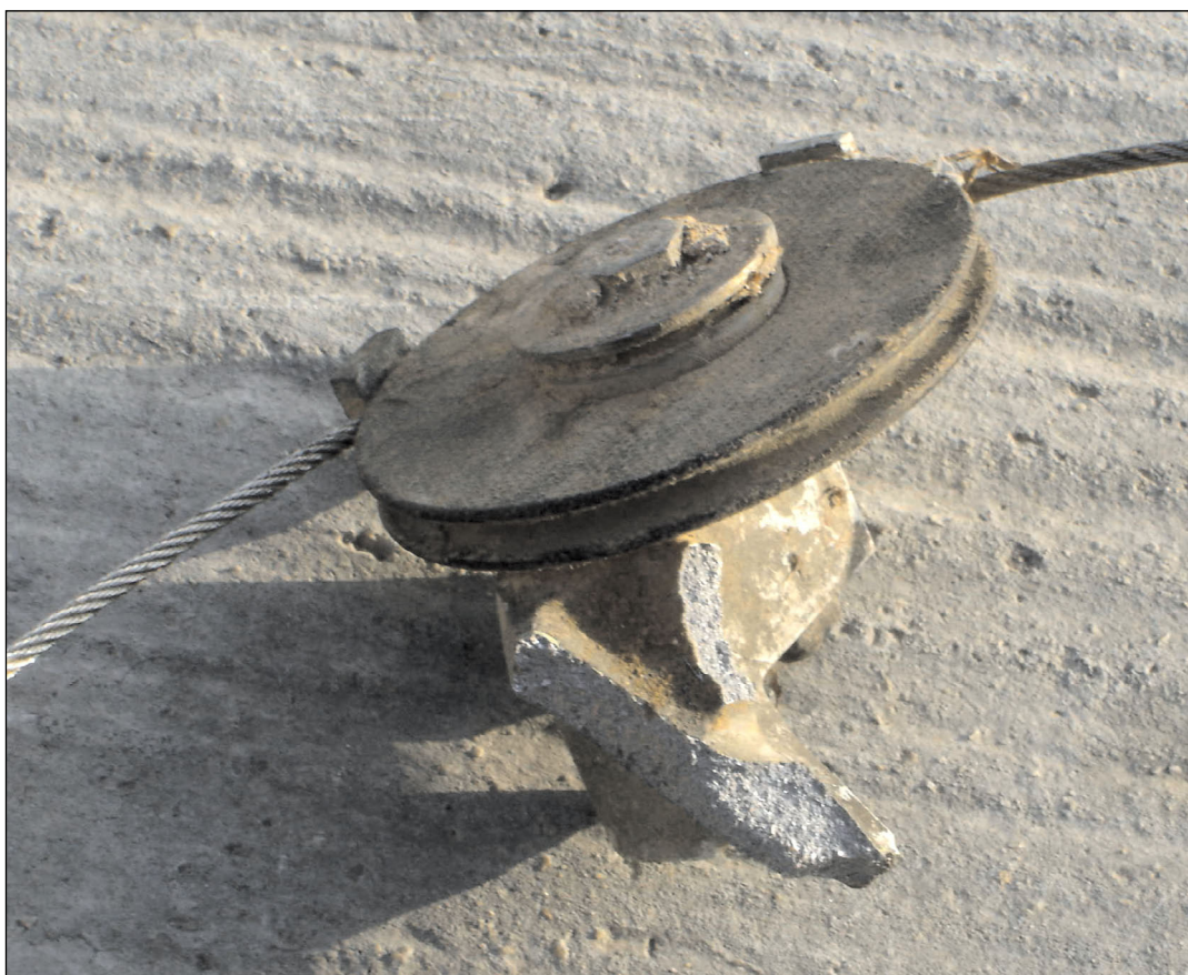
Fotos 1.6.2.1 y 1.6.2.2. Cada parte del cable roto fue enviada al laboratorio
