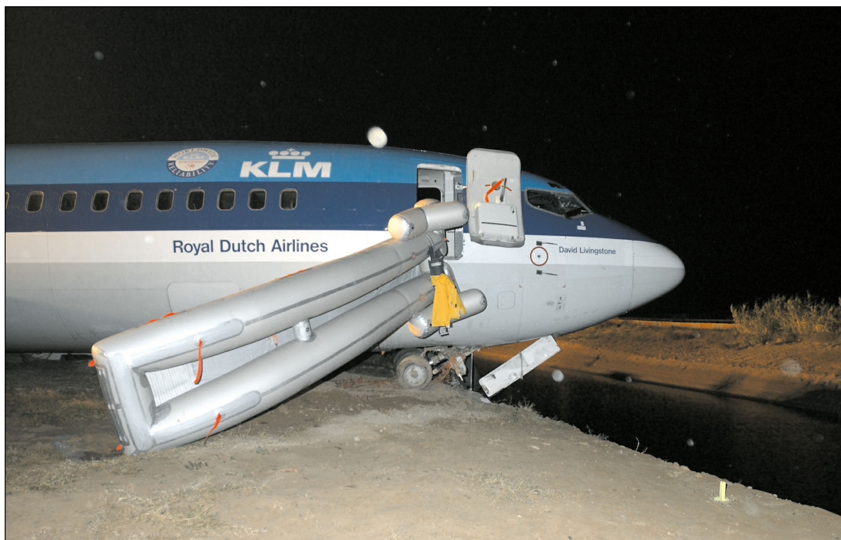
Foto 1.15.2. La rampa de salida de la puerta 1R estaba torcida
