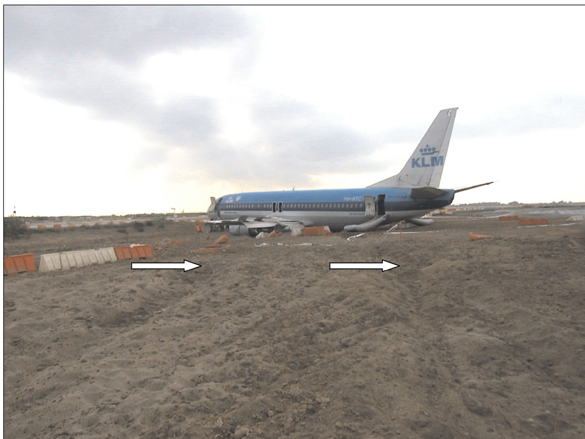
Foto 1.12.1.1. Se ha marcado mediante flechas la posición de la tubería enterrada en las huellas del LH MLG y NLG
