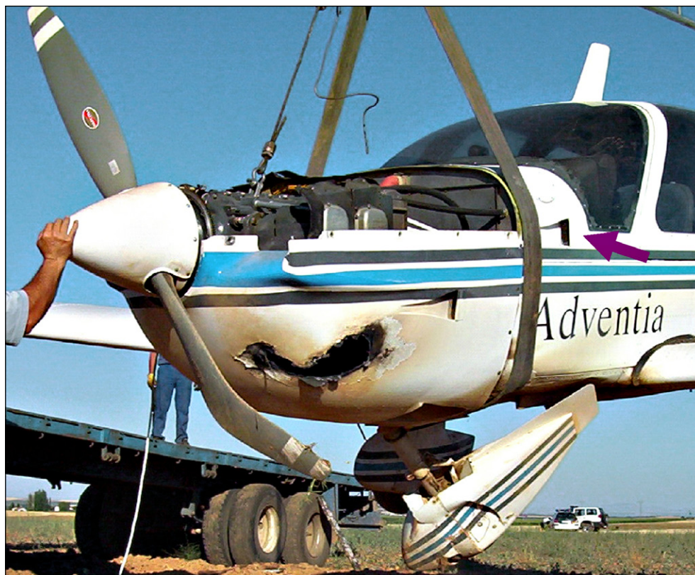
Figura 2. Se produjeron dos agujeros por calor o fuego en la cubierta del motor. Una pala no está dañada. El camino seguido por el humo hacia la cabina es por la entrada de aire externa (marcado con una flecha)
