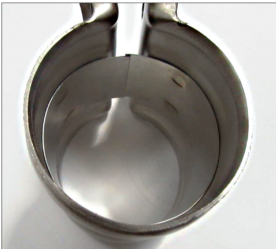
Figura 5. Cuando se aplica par de apriete a las orejetas de esta nueva abrazadera, el labio derecho de la pestaña flexible interior pasa por encima del labio izquierdo debido al solape inicial y, por tanto, el borde no se deforma durante el proceso de apriete
