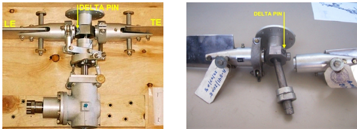
Figura 7. Montaje del spindle de acuerdo con el Compliance Procedure de CHR (foto de la izquierda); y montaje encontrado en el rotor de cola (foto de la derecha)
