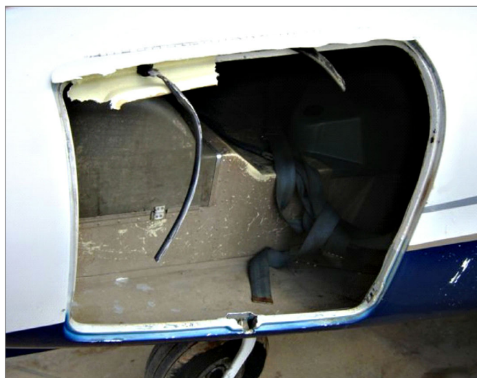
Foto 1. Bodega de equipaje delantera y restos de la puerta desprendida
