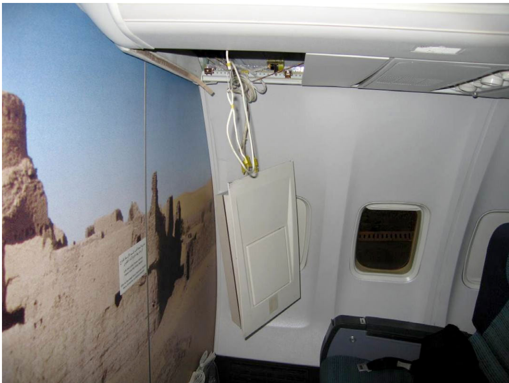
Foto 6. Cabina de pasajeros. Panel de sobrecabeza desprendido
