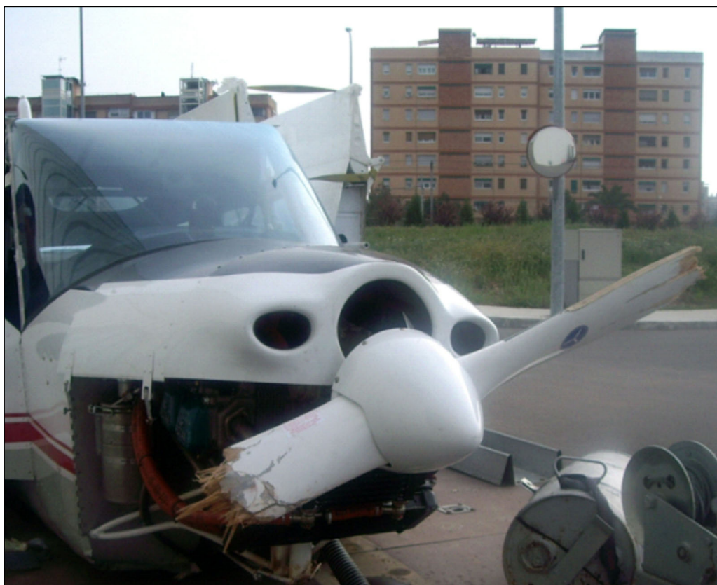
Figura 2. Fotografía del estado de la hélice
