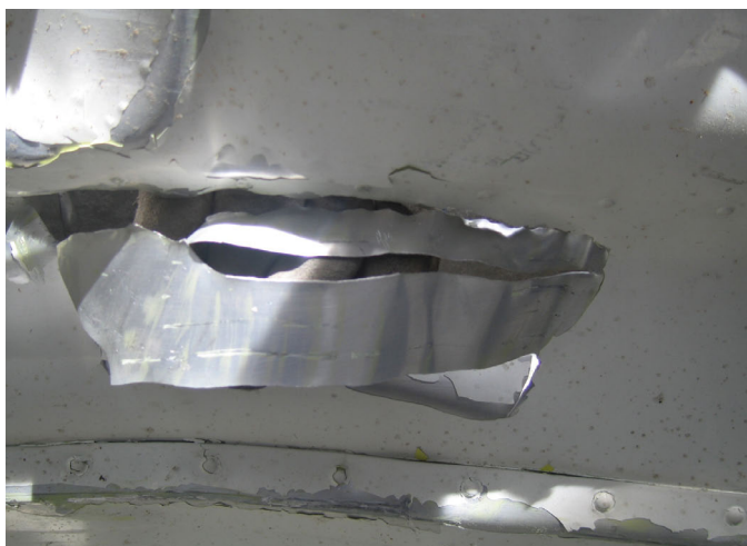
Figura 5. Detalle perforación en el fragmento de plano desprendido
