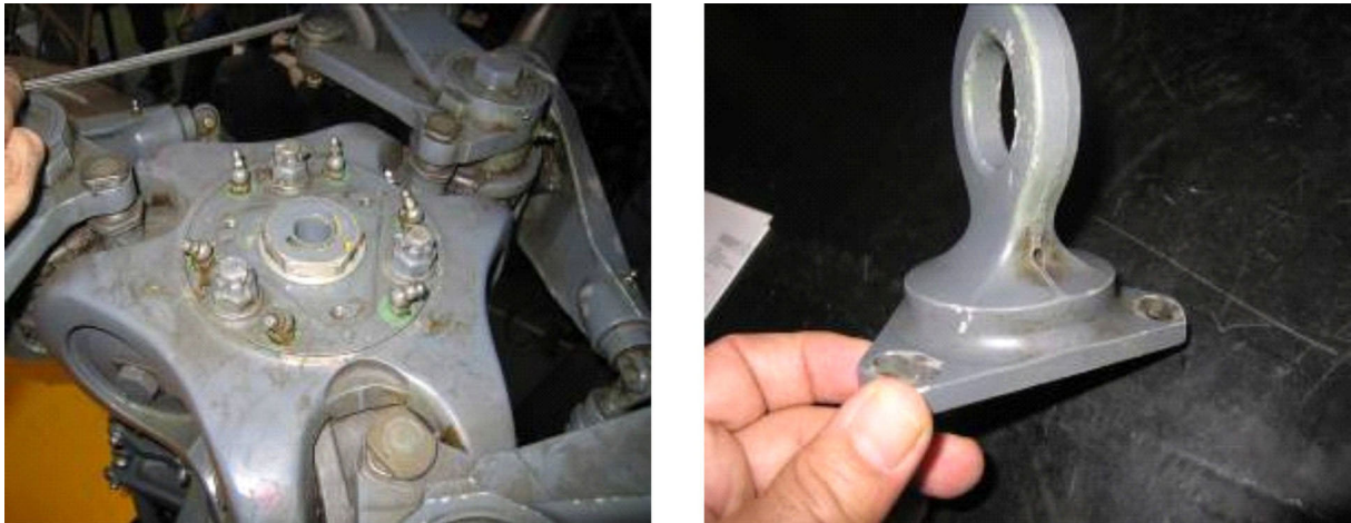
Figura 4. Vista de la parte superior del mástil y del elemento con orificios que monta este modelo de helicóptero
