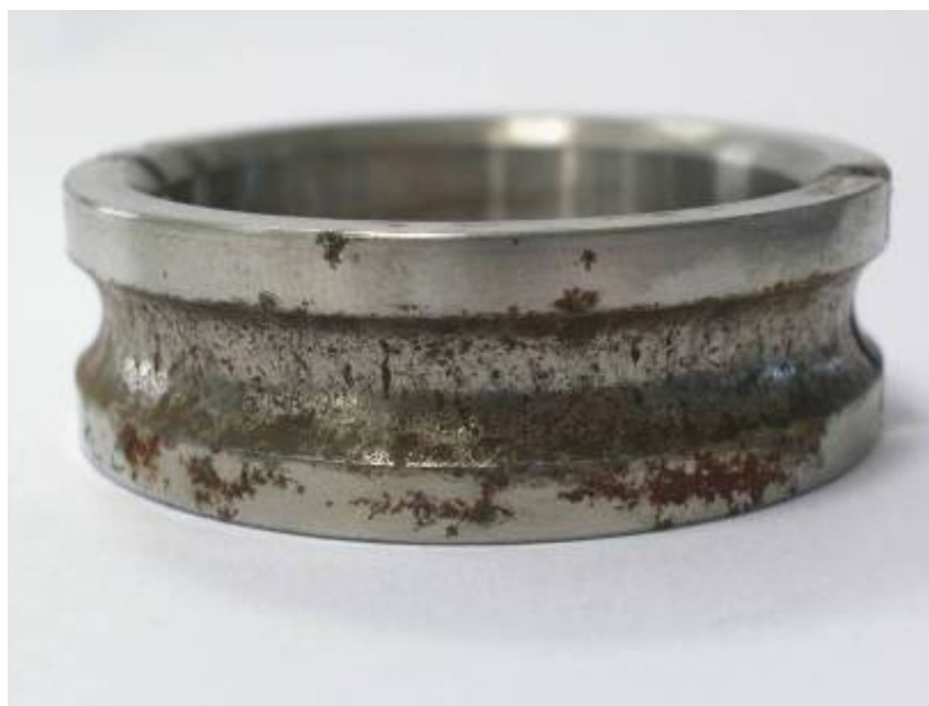
Figura 11. Ejemplo de corrosión encontrada en el rodamiento interno de la rueda libre
