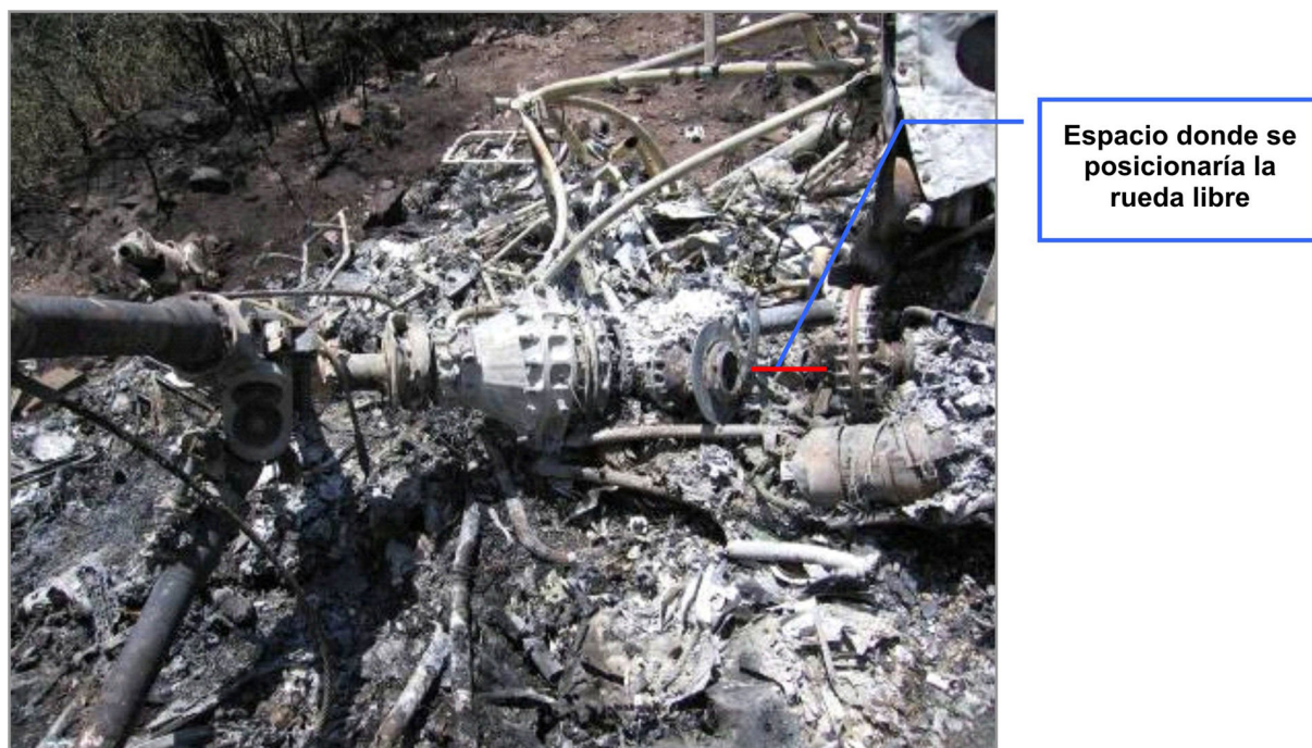
Figura 7. Detalle de los restos de la transmisión principal
