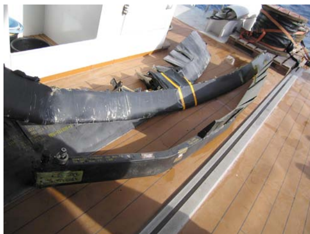
Figura 7. Palas del rotor principal recuperadas
