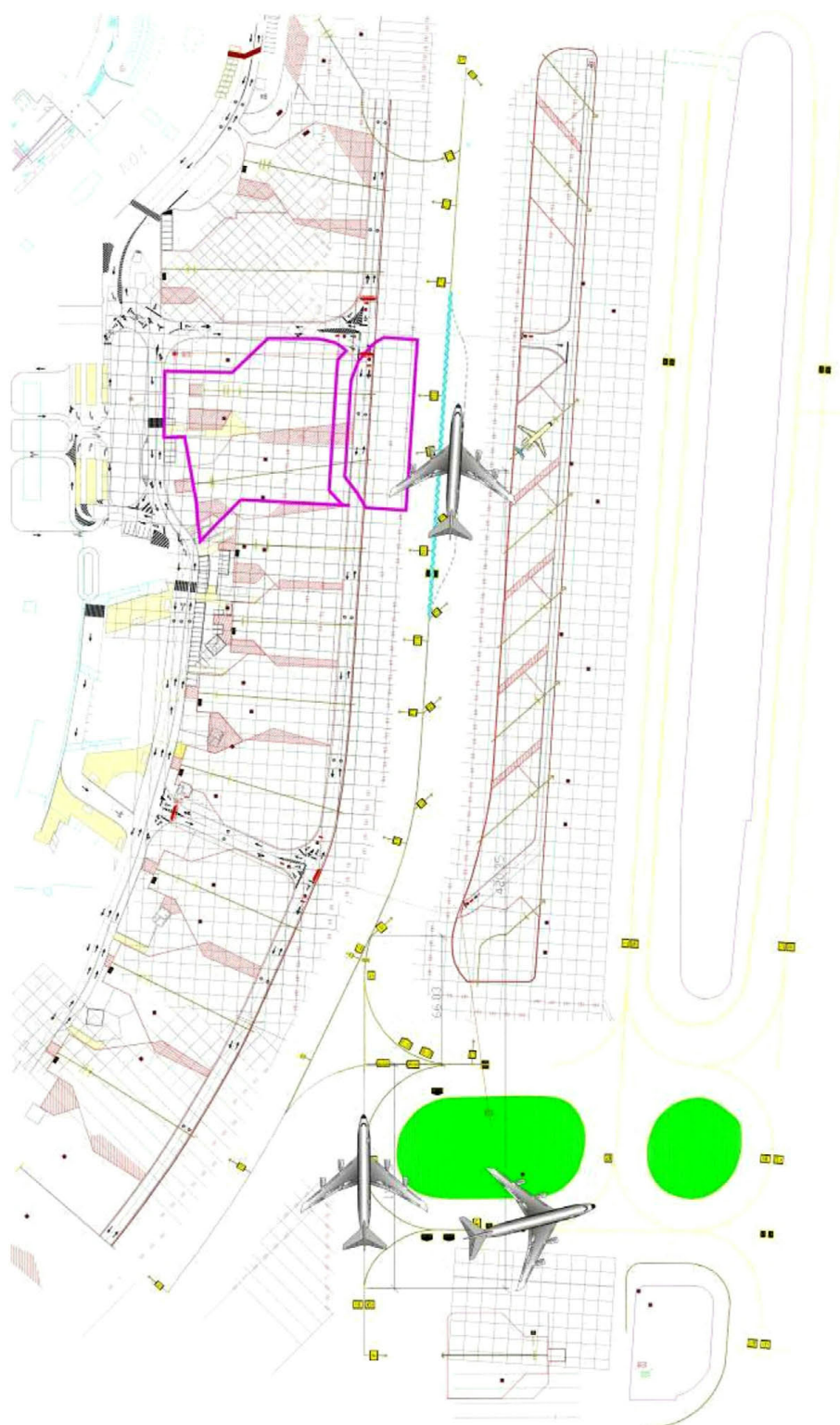
Figura 5. Detalle de la zona del accidente. La línea original del eje de la calle I-8 se muestra en color azul. Estaba desplazado 11 m a la derecha, como se marca con línea de puntos, debido a las obras que había en la zona, envuelta por una línea morada en el gráfico. De acuerdo a las instrucciones de rodaje del AIP, el avión debería haber girado a la derecha hacia M-7 tras pasar la intersección M-6/M-7, como se muestra en la figura
