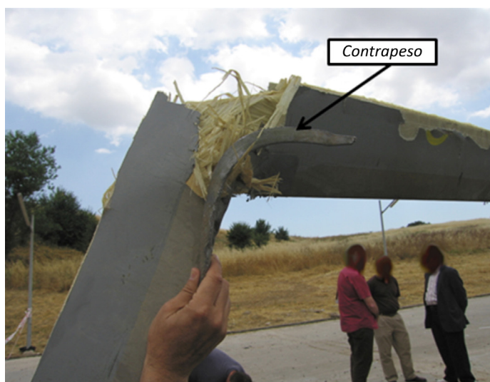
Figura 4. Estado de las palas roja y azul Figura 5. Pala roja. Detalle de contrapeso desprendido
