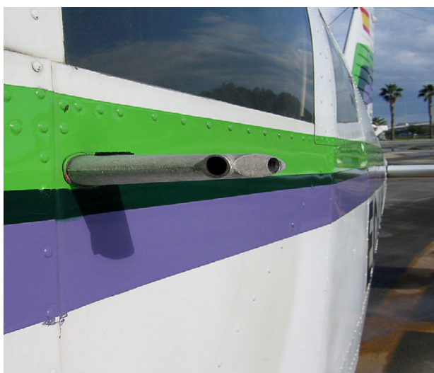
Figura 4. Detalle del tubo pitot/estática que proporciona información del BGE y palanca de extensión en emergencia.
