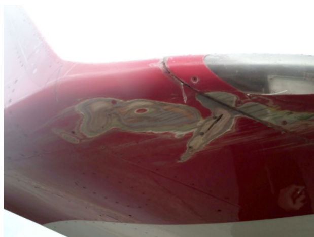
Figura 2. Punta del ala dañada
