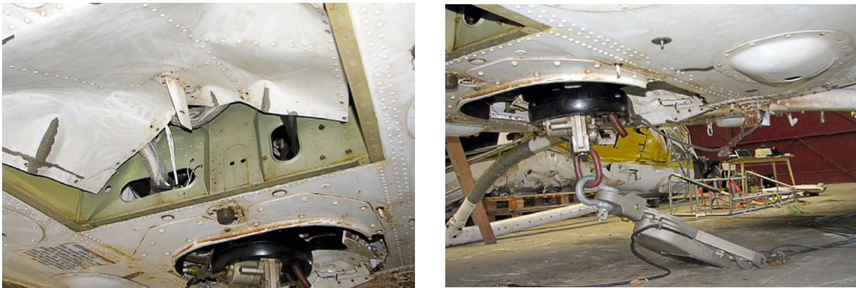
Figura 10. Deformaciones del carenado inferior en la zona del gancho de carga
