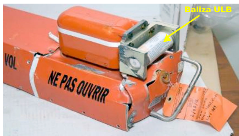
Figura 4. Memoria del FDR en su posición normal
