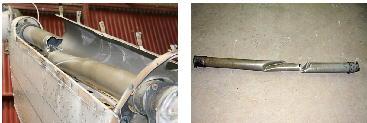
Figura 11. Deformaciones del carenado inferior en la zona del gancho de carga
