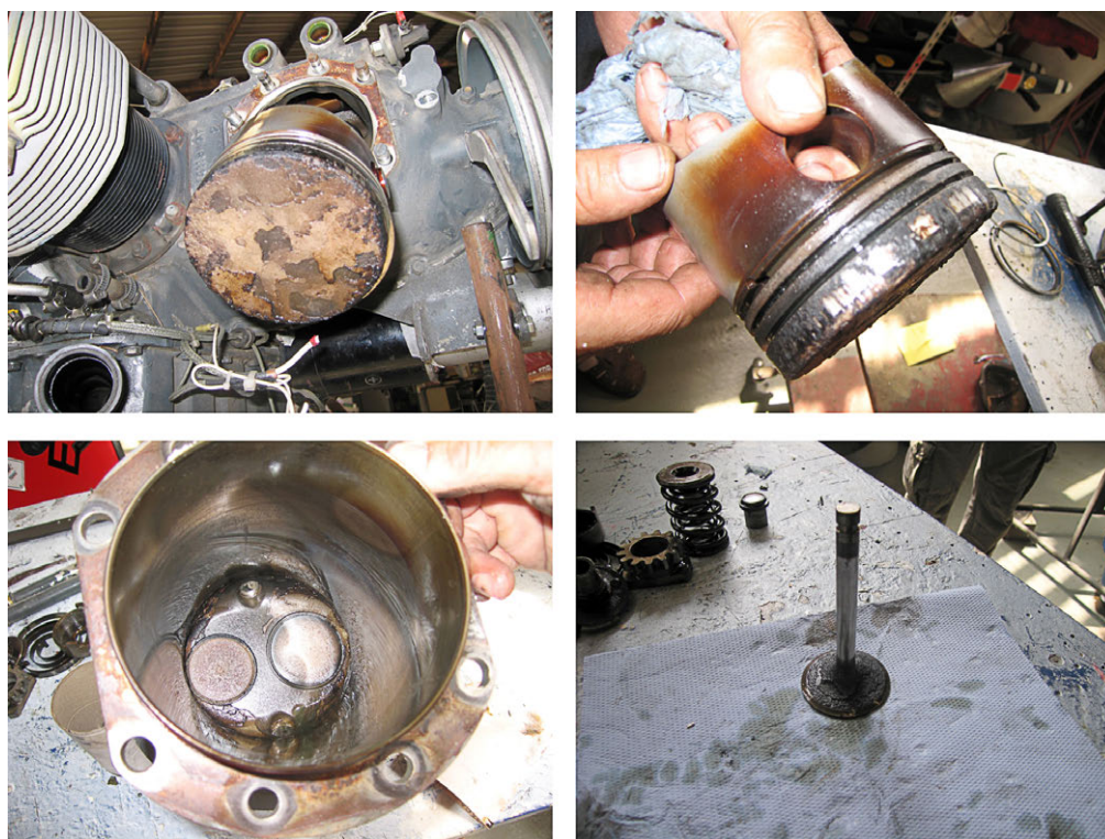
Figura 4. Estado del cilindro n.º 1 y sus componentes
