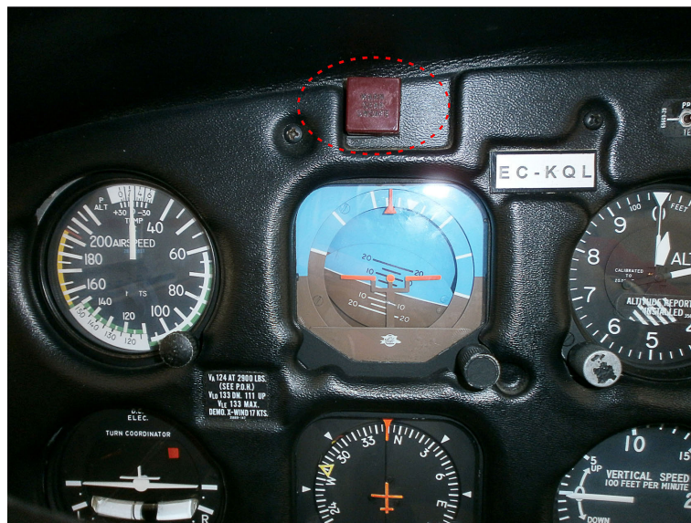
Figura 3. Avisador luminoso rojo de tren inseguro
