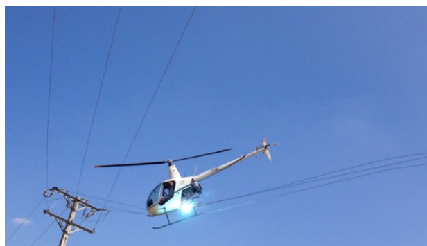
Figura 2. Impacto inicial con los cables
