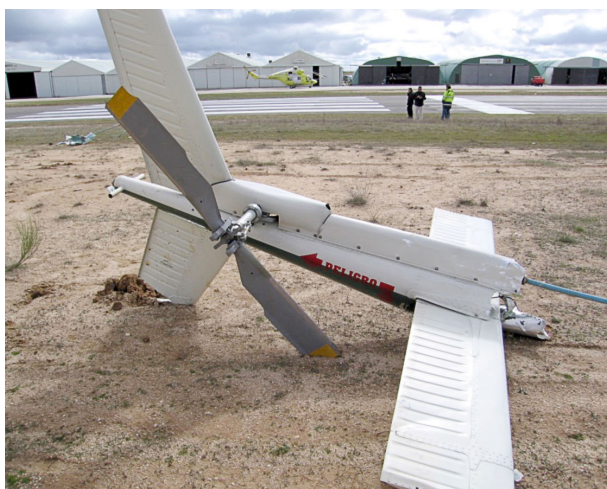
Figura 4. Tramo cono de cola desprendido
