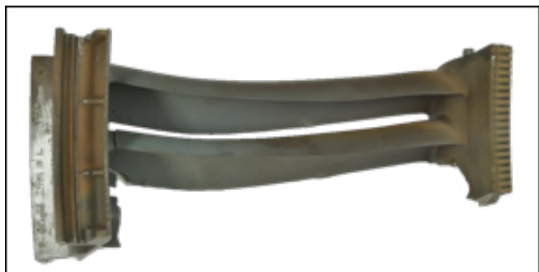
Figura 3. Fotografía del grupo de álabes n° 22 del estátor de la 4ª etapa de la LPT
