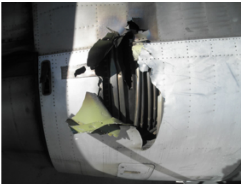
Figura 1. Fotografía de la perforación mayor del carenado de la reversa del motor nº 3
