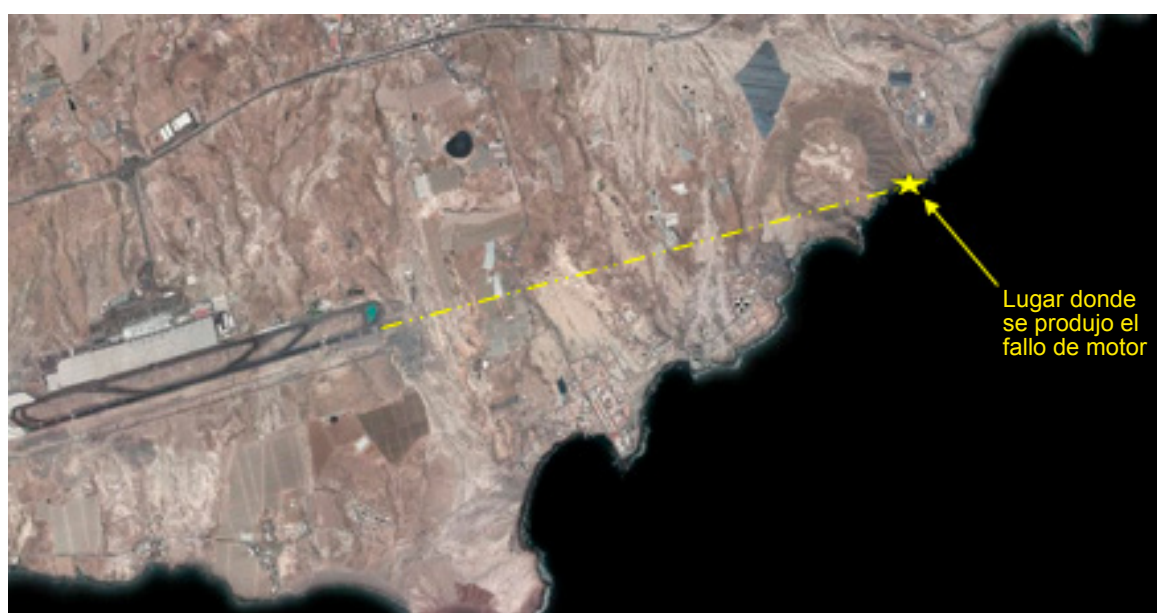
Figura 5. Imagen aérea de la zona donde se encuentra el aeropuerto de Tenerife Sur/Reina Sofía, en la que se ha marcado la trayectoria seguida por la aeronave y el lugar en el que se encontraba cuando se produjo el fallo de motor
