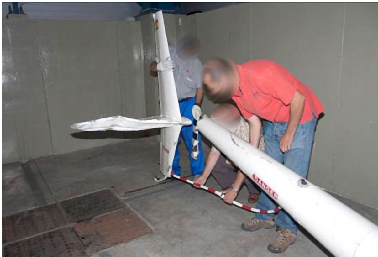
Figura 4. Reconstrucción parte posterior de la cola de la aeronave
