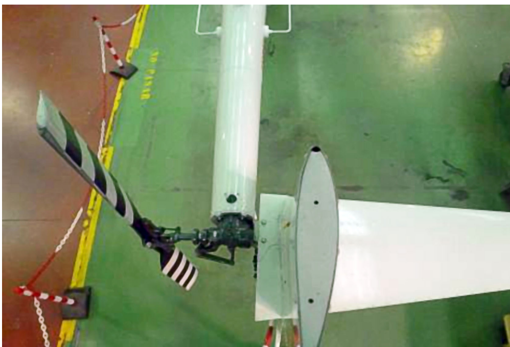
Figura 1. Parte posterior cono de cola, estabilizadores y rotor de cola
