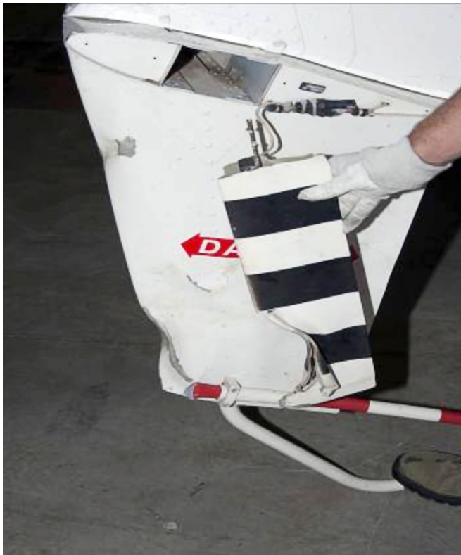
Figura 3. Parte inferior estabilizador vertical y pala golpeada rotor de cola
