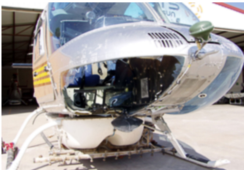
Figura 1. Rotura del cristal inferior del piloto, así como del espejo y su soporte
