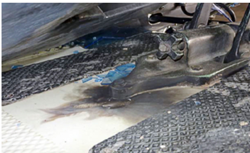
Figura 2. Señales de la descarga eléctrica en la zona de los pedales
