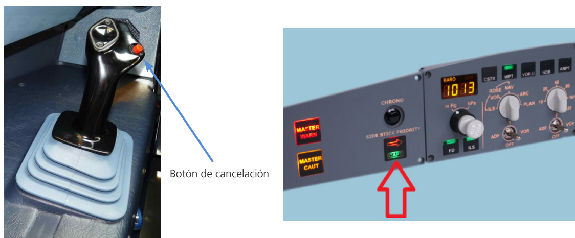
Figura 1. Palanca de mandos A320 e indicador de prioridad de control
