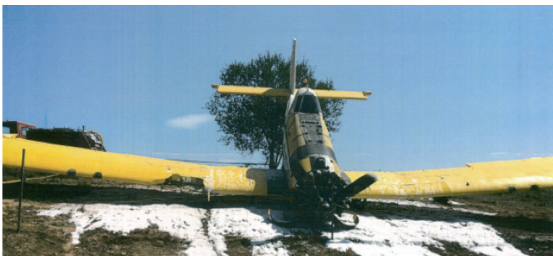
Fig. 2. EC-FAT. Detalle de los daños en el plano derecho
