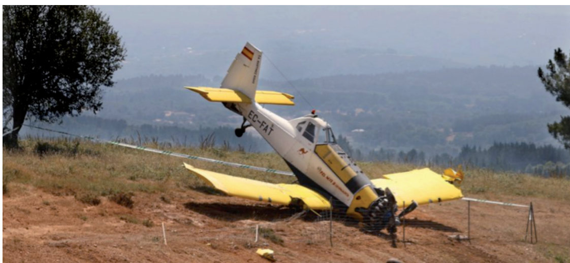
Fig. 3. EC-FAT. Detalle de los daños en el plano izquierdo
