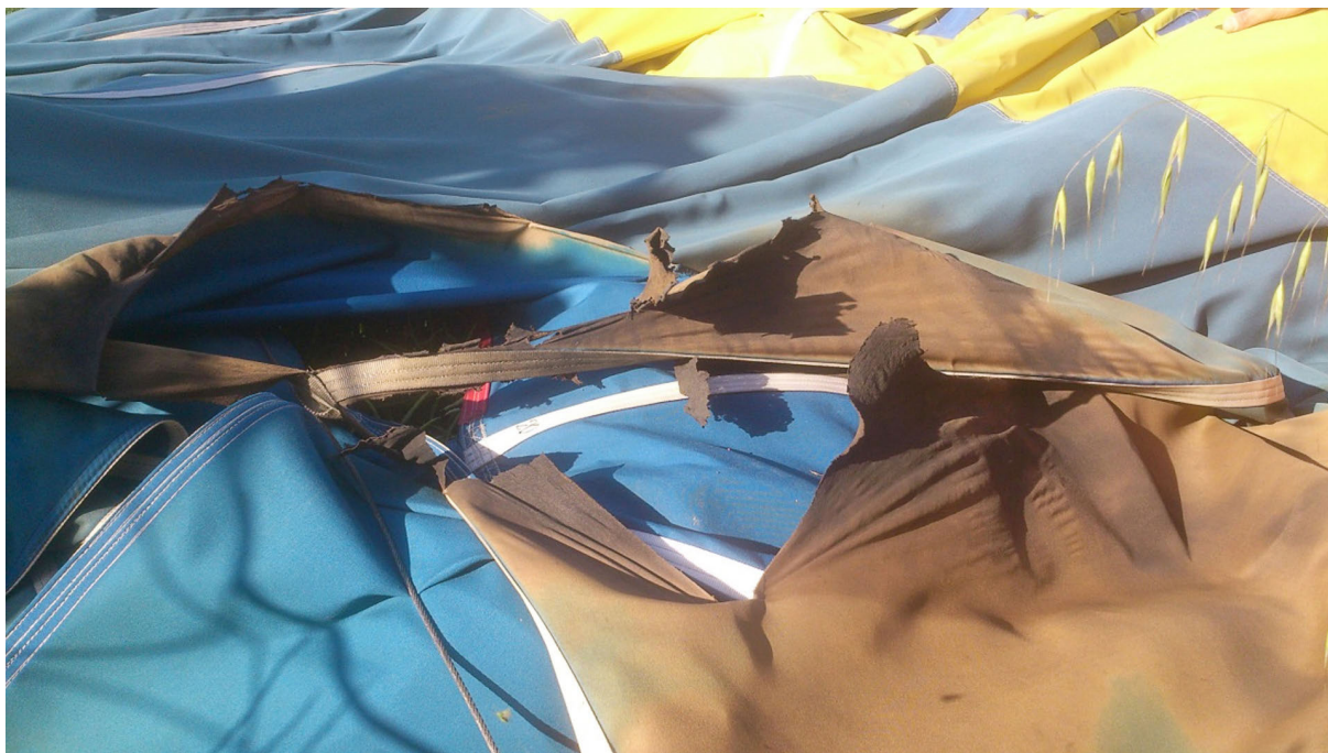
Figura 2. Panel de la vela roto por quemadura
