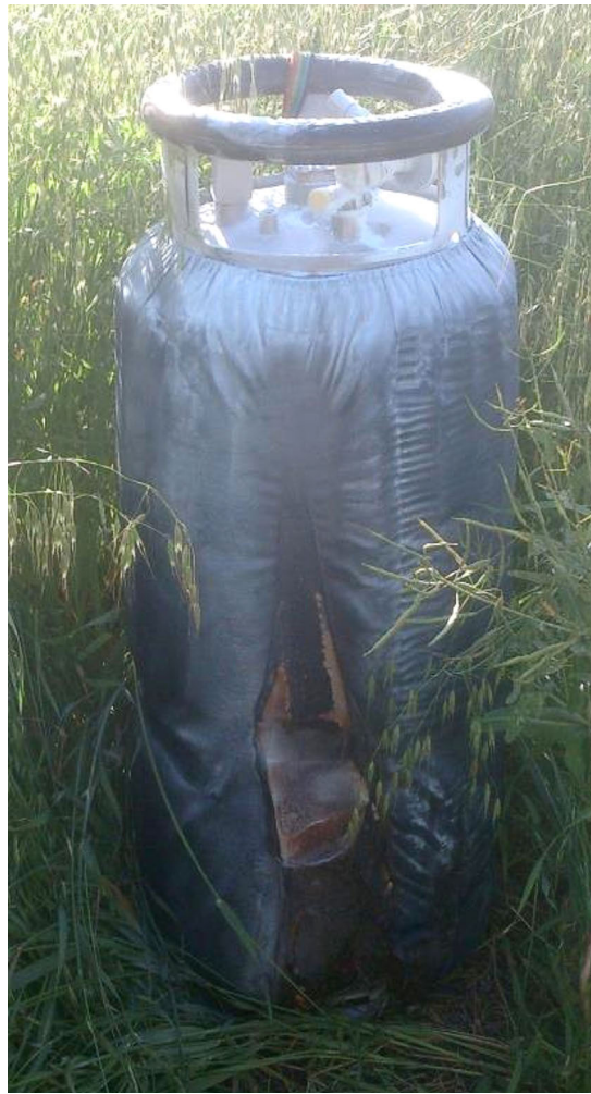
Figura 6. Funda de protección de botella de combustible quemada
