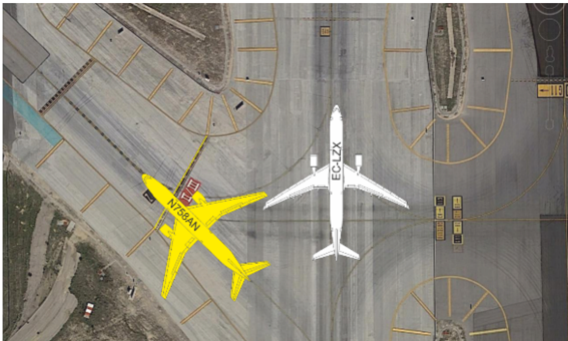
Figura 1. Croquis de las posiciones de las aeronaves en el momento del choque
