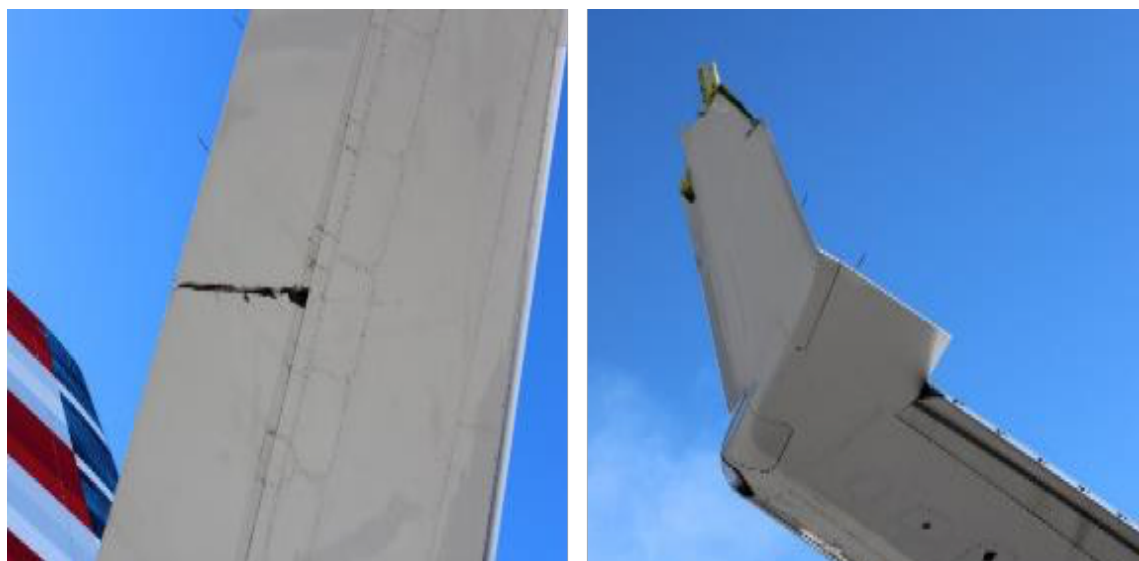
Figura 3. Fotografía del corte producido en el timón de profundidad derecho de la aeronave N758AN (izquierda) y del extremo del plano izquierdo de la aeronave EC-LZX (derecha)
