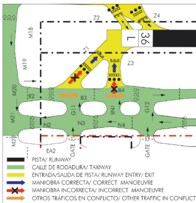
Figura 19. Información sobre el punto crítico de los puntos de espera Z1 y Z3 publicada en el AIP-España
